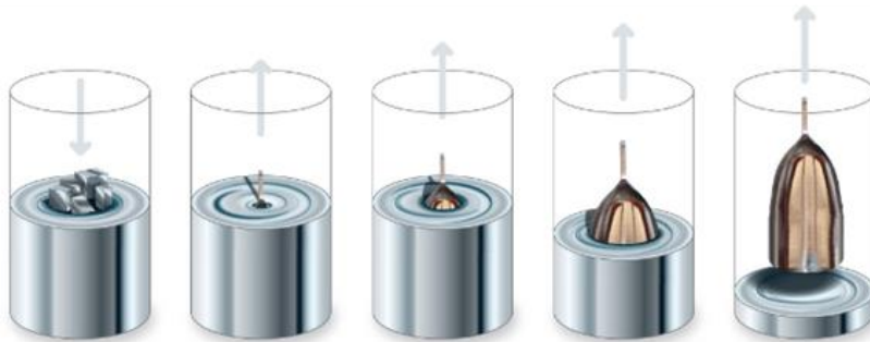
拉出矽晶柱的過程
